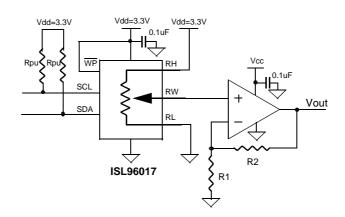
FIGURE 10. TYPICAL APPLICATION DIAGRAM FOR IMPLEMENTING ADJUSTABLE VOLTAGE REFERANCE
